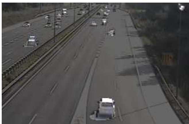
Slika 3: Maska objektov v PAL resoluciji, oddaljena vozila so zelo majhna, napake senc in pri občestni svetilki.
